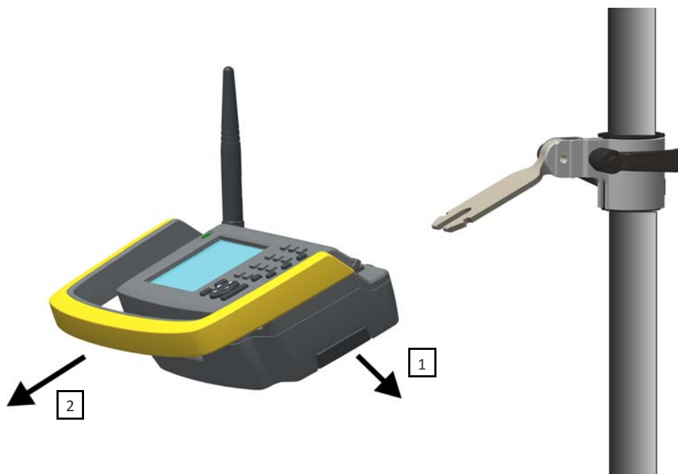
Рисунок 5.18 Отсоединение держателя Trimble Robotic с адаптера стандартной вехи
