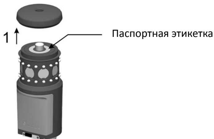
Рисунок 5.11 Расположение паспортной таблички отражателя Trimble MultiTrack
