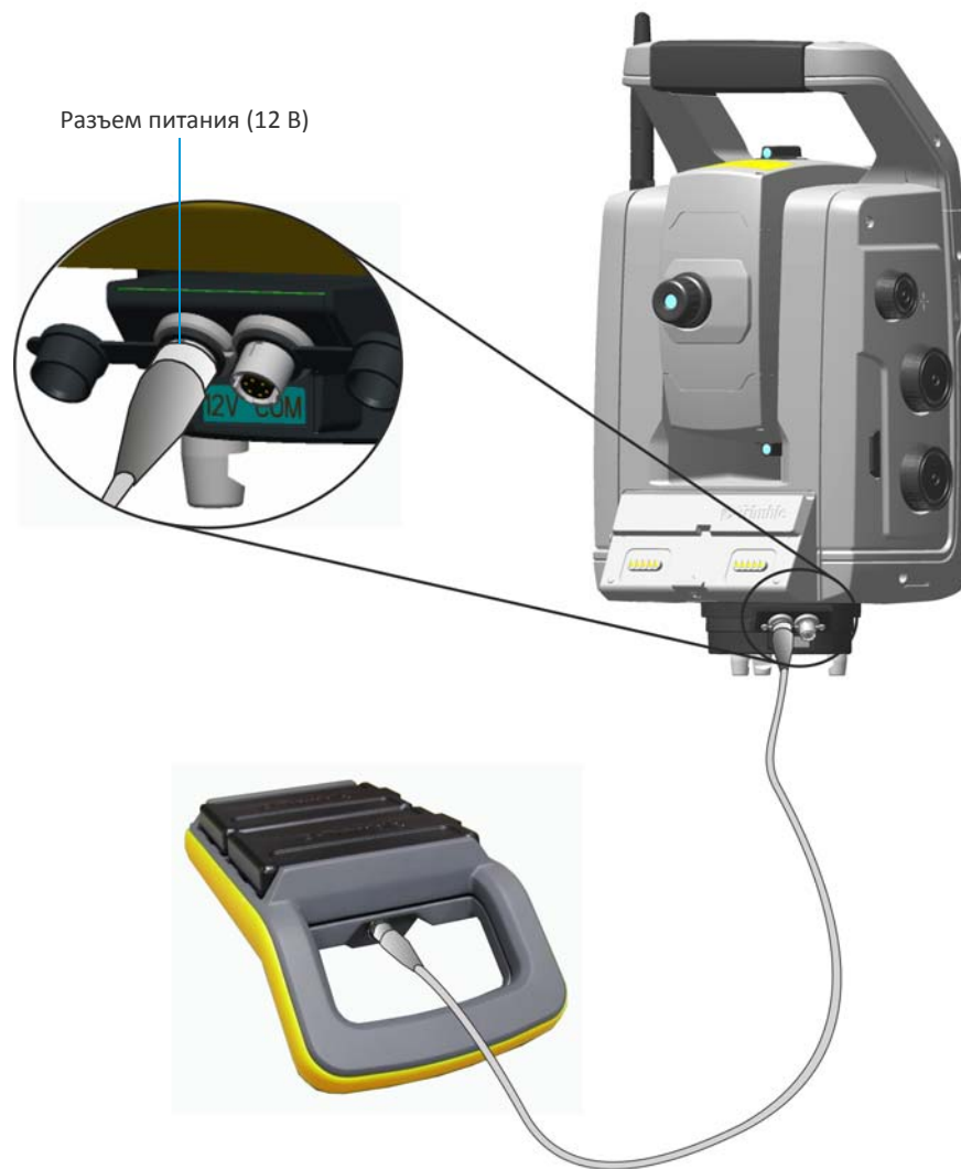
Рисунок 5.2 Подключение адаптера для нескольких батарей
