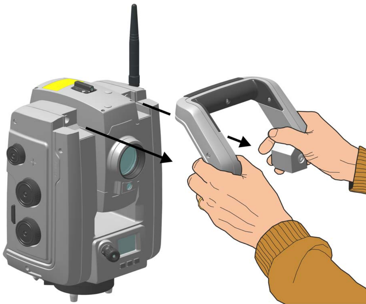
Рисунок 2.14 Отсоединение рукоятки инструмента
