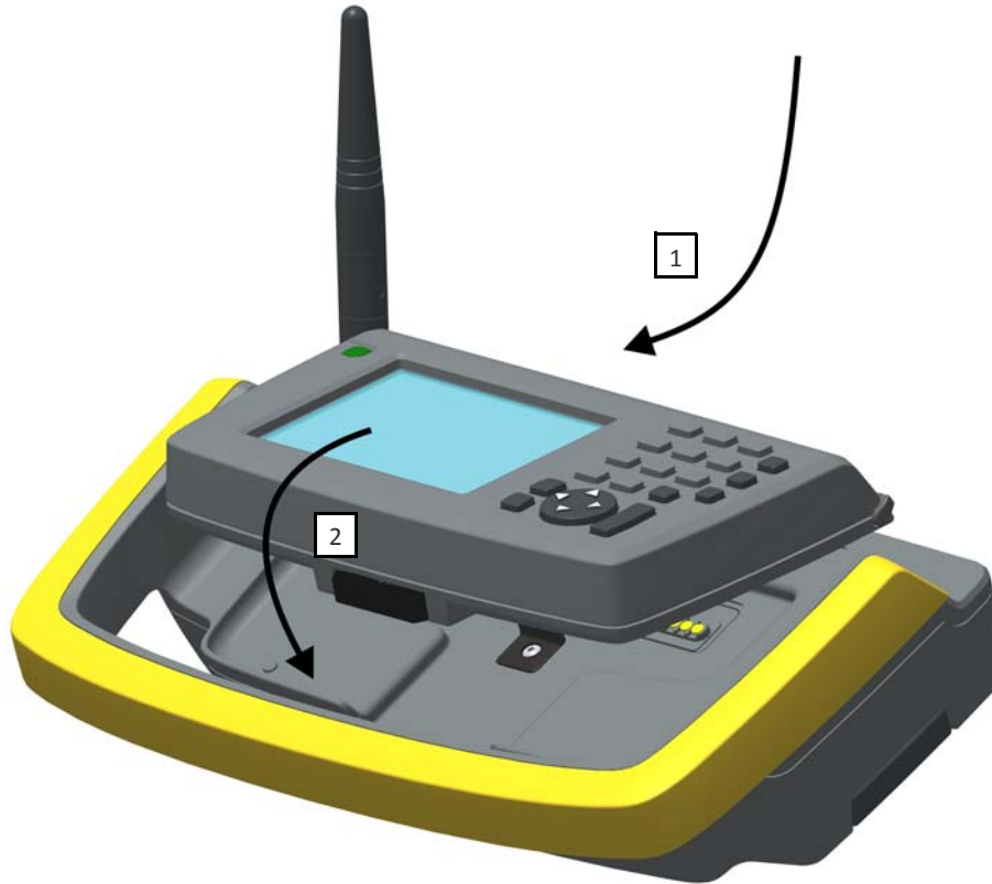
Рисунок 5.15 Установка контроллера Trimble CU на держатель Trimble Robotic
