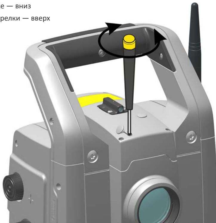
Рисунок 3.7 Юстировка положения лазерного указателя по вертикали
