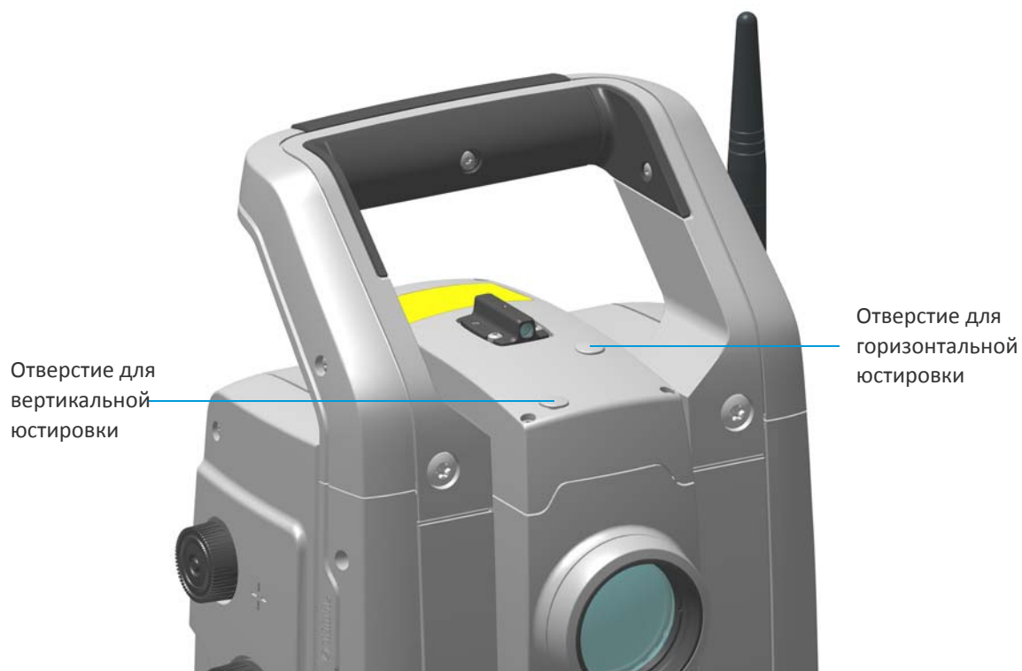
Рисунок 3.6 Отверстия юстировочных винтов лазерного указателя
